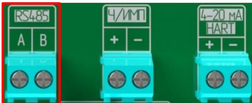
Рисунок 4.9. Клеммы для подключения интерфейса RS-485
