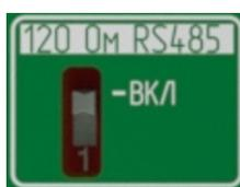
Рисунок 4.11. Включение терминального резистора
