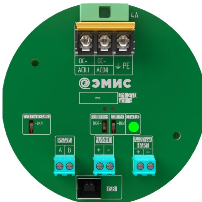
Рисунок 4.1. Плата разъемов и клемм
