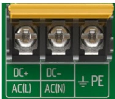
Рисунок 4.2. Клеммы для подключения электрического питания
