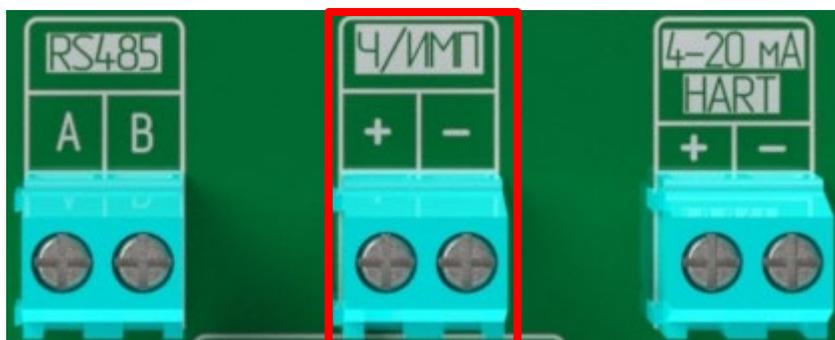
Рисунок 4.5. Клеммы частотно-импульсного выхода
