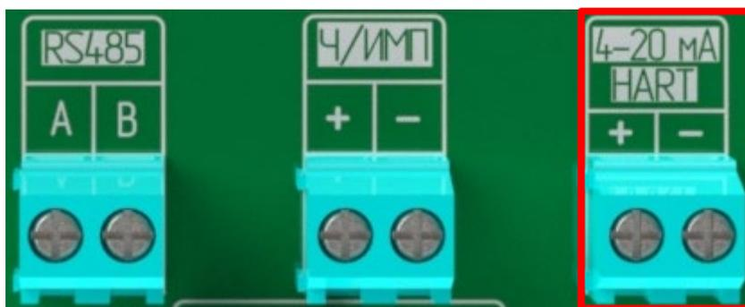
Рисунок 4.7. Клеммы подключения токового выхода
